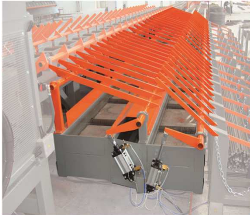
9. T: Lageroptimierer ermöglichen die Fertigstellung und Längsverschiebung von Stangenbündeln, die anschließend gebogen werden müssen
