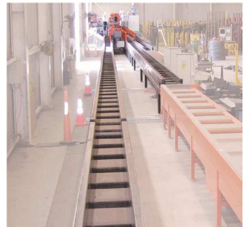
8. PT: Rollenbahn ermöglicht Längsübertragung von Stangenbündeln
