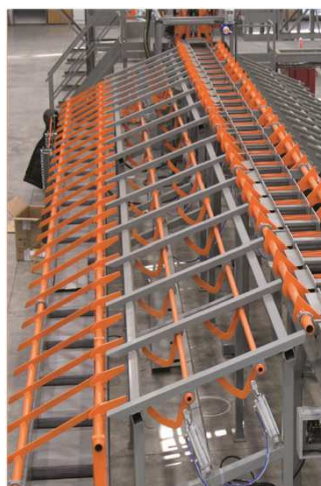
16. SDS: pneumatischer Lagerungsschieber, Schlitten mit 2 pneumatischen Armen zur Stangensammlung, in der Lage, die Stangen an den Biegetisch oder Biegeroboter zu übergeben
