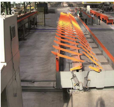
6. CPO: Mobiler optimierender Rollenwagen zum Lagern und Umsetzen von zugeschnittenen Paketen oder Stangen auf nachfolgende Bearbeitungsschritte
