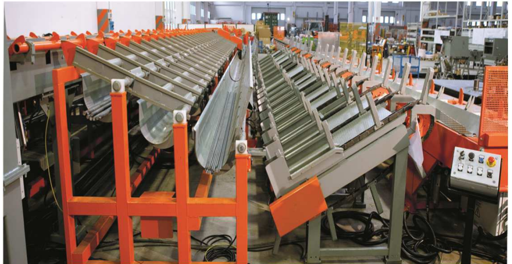
4. Pocket: schallgedämmte Ladeschalen, können ohne Prioritäts- oder Sequenzbeschränkung geladen und entladen werden
