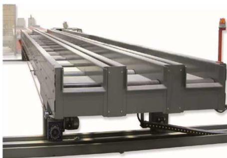
7. CP: mobiler Rollenverteilerwagen zum Lagern und Umladen von Stangenbündeln auf spätere Arbeitsgänge
