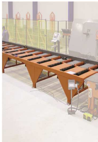
13. B12 MFC: Biegetisch mit 2 Rollenbahnen, 1 Spur mit motorisierten Rollen und 1 Rolle mit Leerlaufrollen
