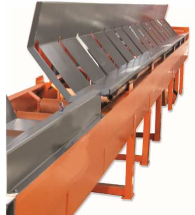
11. VRP: Verteilerschienen ermöglichen das Lagern von geschnittenen Stäben und dienen als Lagereinheit für nachfolgende Arbeitsvorgänge
