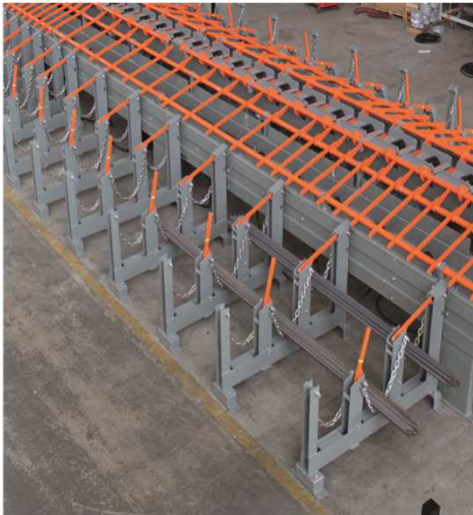
3. Rack: Das Rack ermöglicht es, die geschnittenen Stäbe zu sammeln und zu Bündeln zu verarbeiten, wenn keine weitere Bearbeitung erforderlich ist
