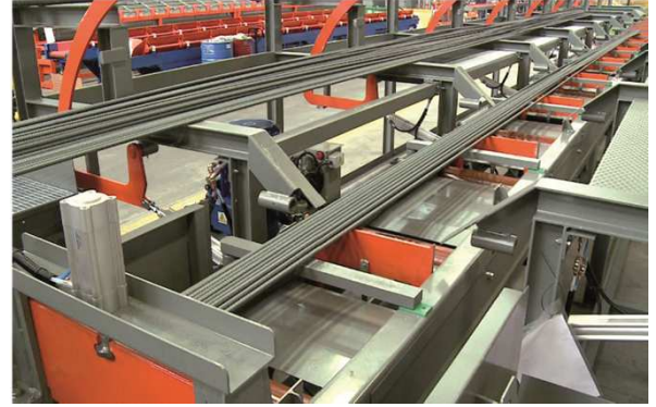
2. VA: Vorlagersystem mit rotierenden Armen am Einlaufband
