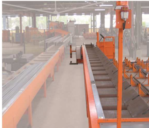
10. CC: Mobiler Kommissionier Wagen zum Entladen der geschnittenen Stangen auf den Boden, Klassifizieren der spezifischen Ablagerungen
