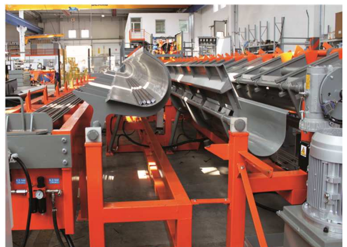
17. Hebepuffer: nimmt die Stäbe aus den Scherentaschen und hebt sie auf die Rollenbahn des Biegeroboters
